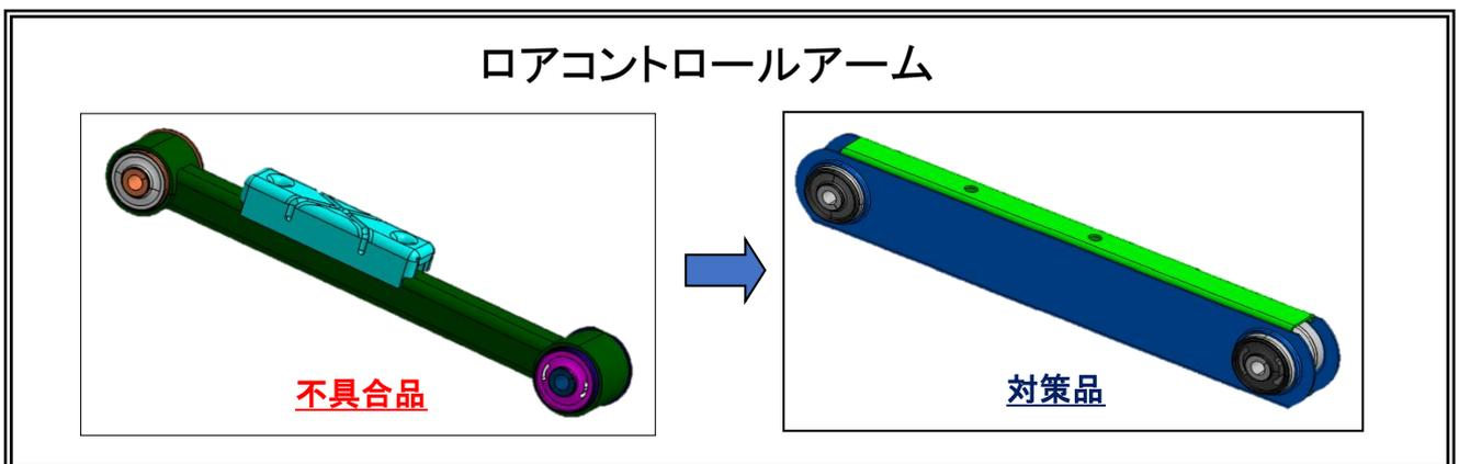
リアサスペンションのロアコントロールアームの設計が不適切なため、ロアコントロールアーム内に侵入した雨水が適切に排出されないものがある。そのため、腐食が生じ、最悪の場合、ロアコントロールアームが折損するおそれがある。
